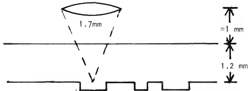
FIGURE 3 — CONSTANT LINEAR VELOCITY DISC
